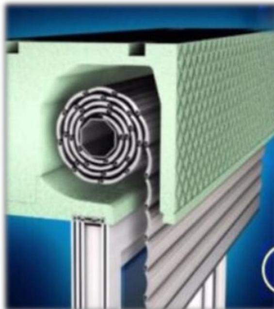
Monoblocco avvolgibili: Spalle laterali spessore 55 mm costituite da lastra in fibrocemento con nessun assorbimento di umidità da 5 mm pronte da pitturare; pannello isolante in polistirene estruso. Due profili in alluminio, uno esterno che determina il salvaspigolo per l'intonaco e uno interno che funge da falso telaio per il serramento. Guide di scorrimento in alluminio estruso
